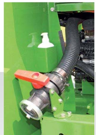
Llenado por presión (acoplamiento C o Kamlok)
