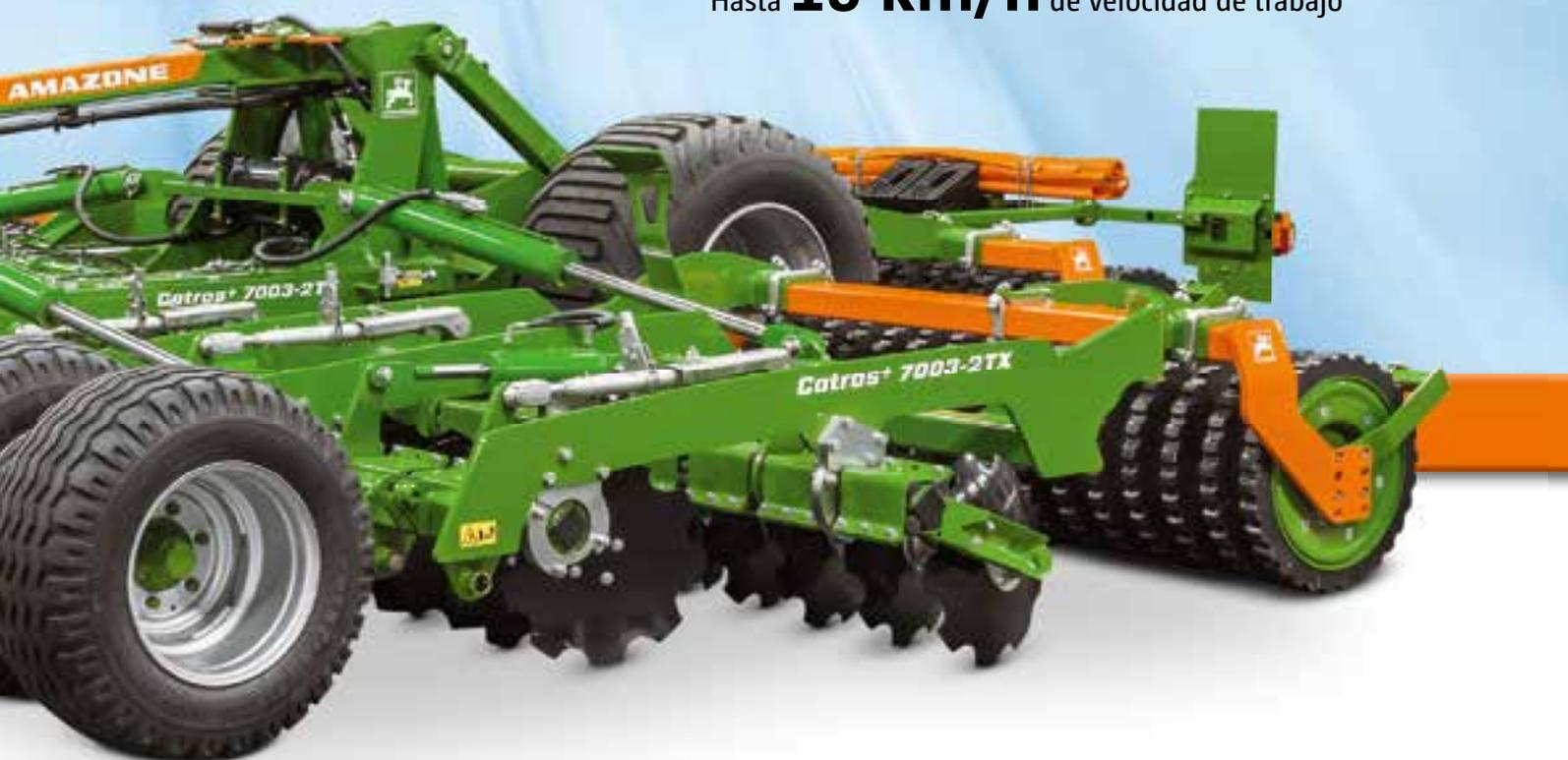
La grada de discos arrastrada Catros<sup>+</sup>-2TX resulta perfectamente adecuada para el tratamiento del suelo superficial y con gran intensidad de mezcla. El tren de rodaje medio otorga a la máquina una especial maniobrabilidad y propicia una mayor seguridad y rapidez en los trayectos por carretera, pese a las anchuras de trabajo de 7 a 9 m. Su extraordinaria suavidad y su ligereza garantizan un máximo confort de conducción con el rendimiento más elevado.
