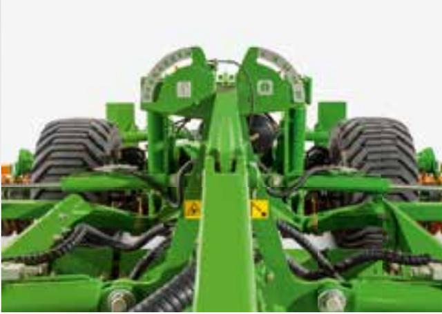
Indicador de profundidad de trabajo Crushboards (izquierda) y del panel de discos (derecha)
