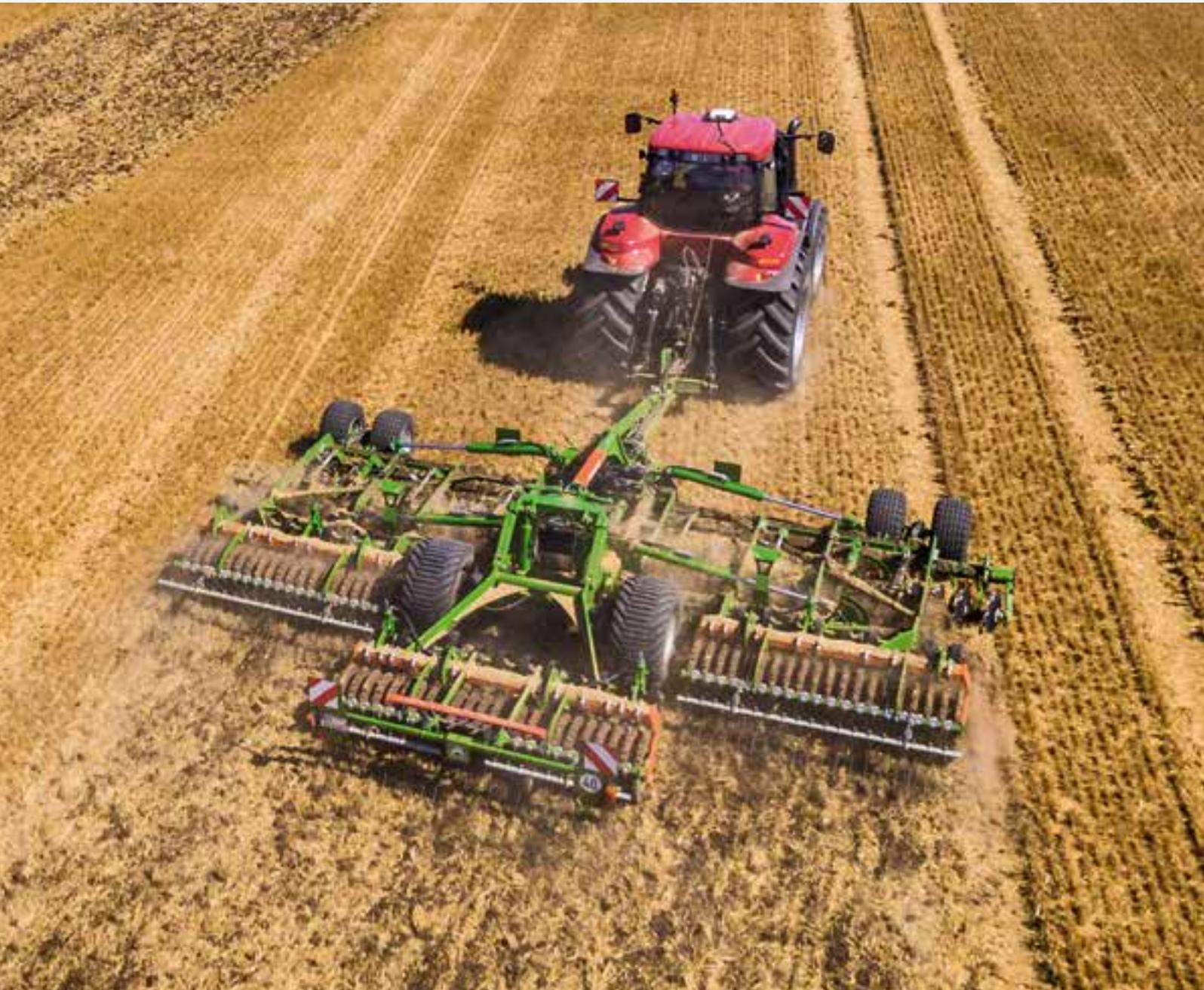
Catros<sup>+</sup> 8003-2TX con rodillos de anillo cónico con perfil de neumático Matrix en una anchura de trabajo de 8 m
