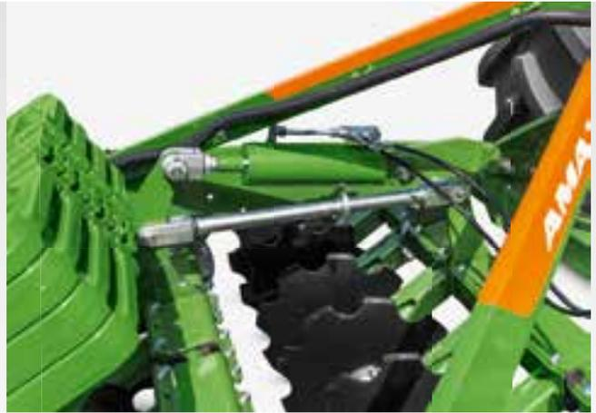
Ajuste hidráulico de la profundidad de trabajo
