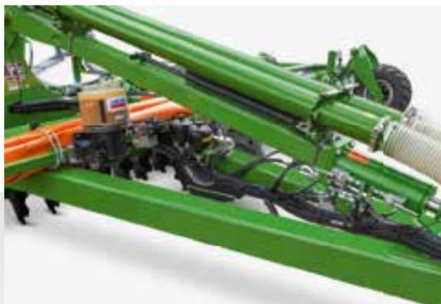
Sistema de lubricación centralizada en la Catros<sup>+</sup> 12003-2TS
