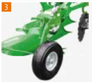
**3** Rueda con Ø de 550 mm con neumáticos x 160 mm de ancho
