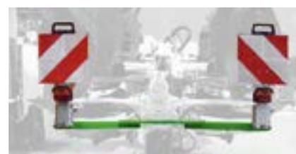
Todos los arados Cayros deben equiparse con un sistema de iluminación para el transporte por carretera. Opcionalmente con señalización a la izquierda (para el transporte con arado en posición de trabajo) o también en ambos lados en caso de utilizar una rueda de apoyo para transporte, esta iluminación garantiza la seguridad al circular por la carretera.
