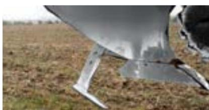
Fieles a la máxima «arado plano y descompactación profunda», con las puntas de subsolador se logra una descompactación de las capas del terreno por debajo de la profundidad de trabajo del arado. Las puntas de subsolador pueden regularse en altura y se sustituyen con facilidad, reduciendo así los costes operativos.
