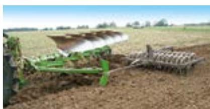
Para el uso combinado con compactadoras, todos los arados Cayros pueden equiparse con un brazo compactador con desbloqueo hidráulico.
