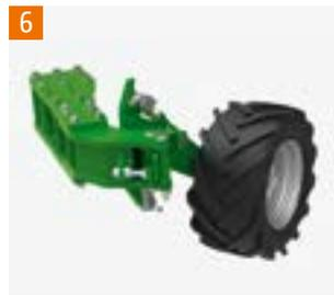
**6** Rueda-Ø de 580 mm con neumáticos de perfil AS x 270 mm de ancho
