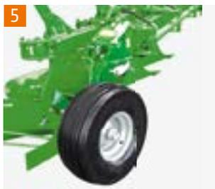
**5** Rueda con Ø de 680 mm con neumáticos x 250 mm de ancho
