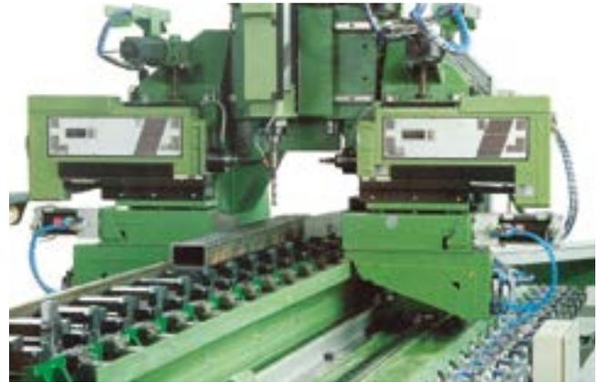
Todos los tubos del bastidor se perforan en una instalación especialmente desarrollada, mientras que todos los taladros se realizan con una sujeción exclusiva que garantiza una precisión absoluta en el equipo acabado.
