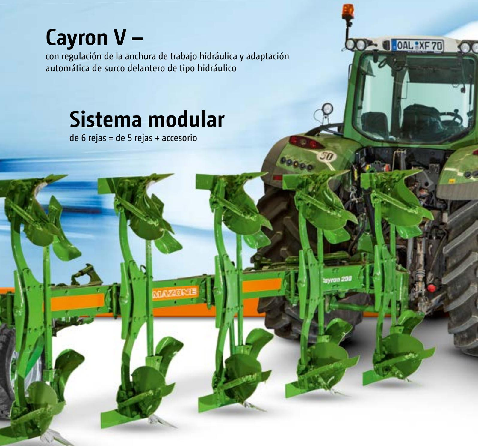
El arado reversible Cayron está disponible con 5 y 6 rejas para tractores de hasta 290 CV. El Cayron 200 permite regular la anchura de trabajo por cada cuerpo en tres niveles: a 40, 45 y 50 cm. El Cayron 200 V está equipado de serie con un sistema hidráulico de regulación de la anchura de trabajo; cuando se modifica la anchura de trabajo, la anchura del surco delantero se adapta automáticamente mediante un sistema hidráulico.
