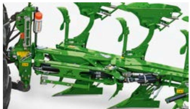
Una ventaja singular que ofrecen de serie los arados Cayron es que durante la basculación del bastidor, previa a la operación de giro, los soportes del cuerpo permanecen inmóviles.
