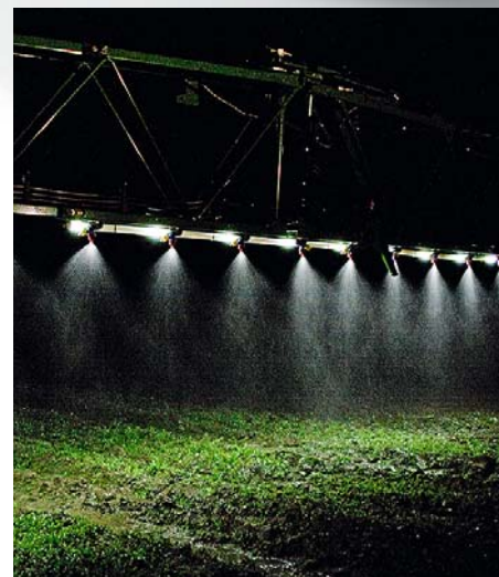
Iluminación por LED en cada boquilla
