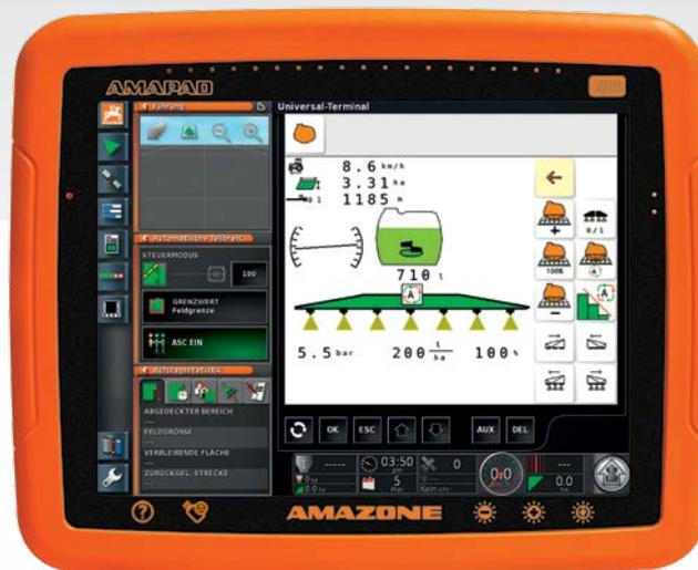
Junto al control de las anchuras parciales GPS-Switch pro se ha instalado también un sistema manual profesional de guiado de calles de serie de alta calidad con GPS-Track pro. GPS-Track pro puede ampliarse hasta el sistema de dirección automática.
