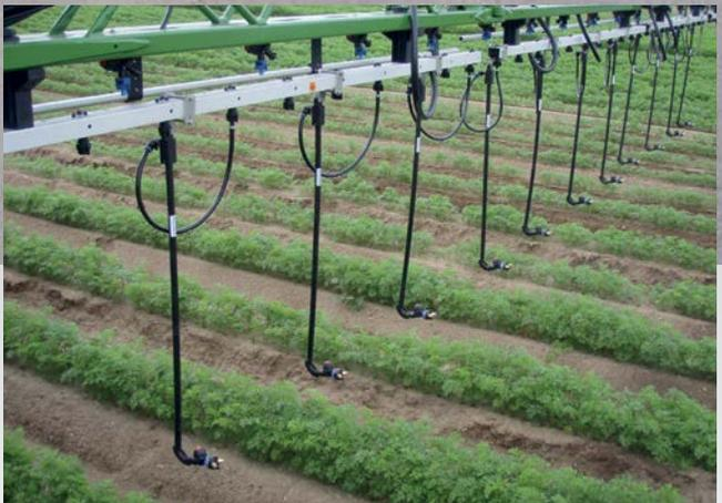
✔ Con las barras de pulverización Super-S, AMAZONE le ofrece soluciones elegantes para el rociado eficaz bajo el follaje en cultivos de hortalizas y maíz. Un buen ejemplo es el sistema Dropleg de la empresa Lechler, un mecanismo de rociado ligero y robusto que oscila libremente, en posición perpendicular con respecto a las hileras, y que cumple con las necesidades de los profesionales más exigentes.
