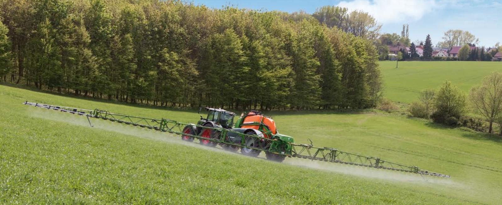
ContourControl con ajuste del ángulo de las barra hacia arriba
