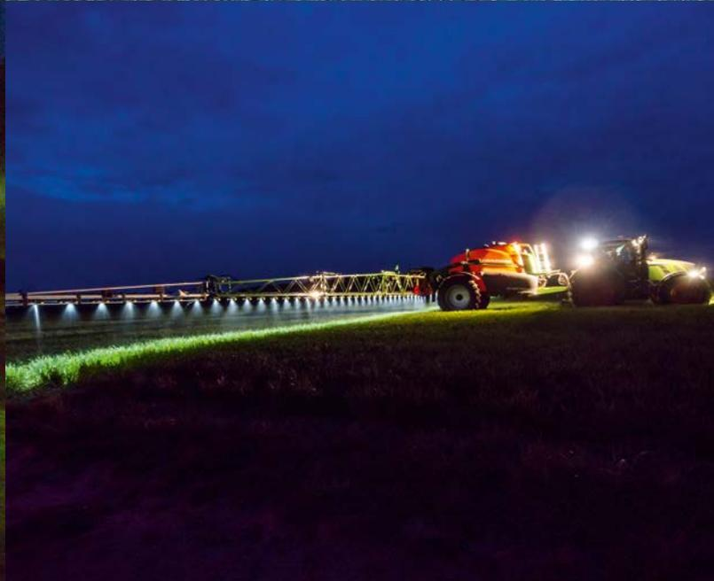
Las nuevas barras Super L2 con nuevo guiado activo del varillaje ContourControl y el sistema de amortiguación activa de oscilaciones SwingStop
