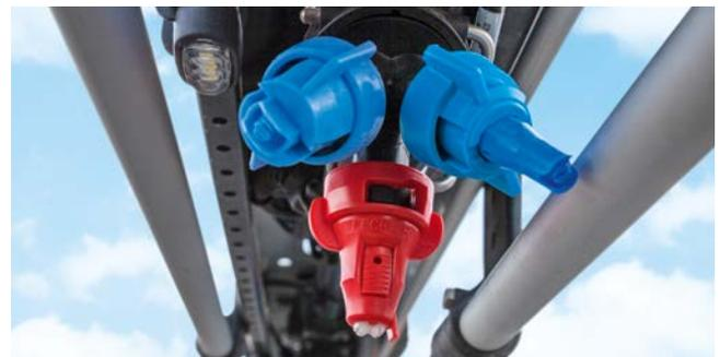
Portaboquillas triple AmaSwitch con iluminación de las boquillas LED
