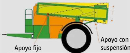
✓ Todo encaja en sus seguros: La barra de pulverización está asentada sin juego y asegurada en la posición de transporte. Los impactos son absorbidos por la suspensión en paralelogramo. Esto es sinónimo de confort absoluto y asegura, sobre todo, la durabilidad de las barras de pulverización.
