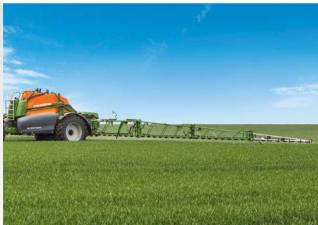
Altura de aplicación por debajo de 50 cm para una distancia entre boquillas de 25 cm
