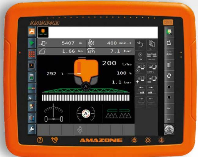
Junto al control de las anchuras parciales GPS Switch pro se ha instalado también un sistema manual profesional de guiado de calles de serie de alta calidad con GPS Track pro. GPS Track pro puede ampliarse hasta el sistema de dirección automática.
