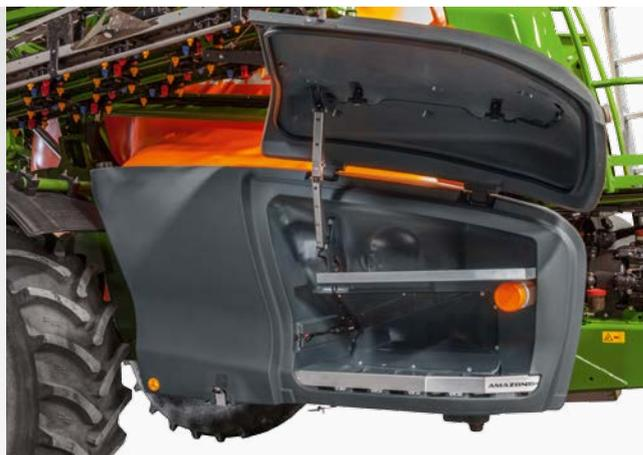
Caja de transporte con una capacidad de 240 l en el lado derecho de la máquina
