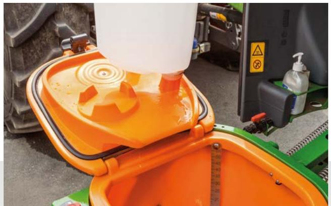
❗ «La tapa robusta no sólo sirve como superficie de apoyo recta para el vaso de medición o para las bolsas de sal de Epsom, sino que también tiene soportes para permitir el vaciado de los bidones enjuagados. Ejemplar».
