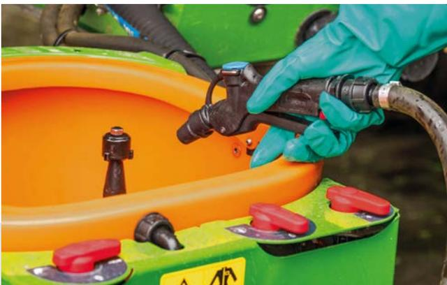
✓ En el lado derecho del depósito de llenado se encuentra la pistola pulverizadora, incluida en el equipamiento de serie.
