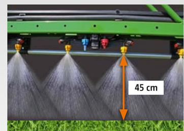
Boquillas 80°: Distancia entre boquillas 25 cm
