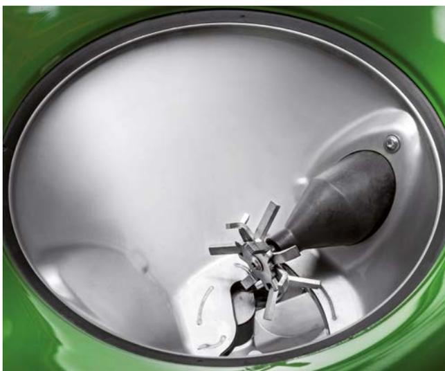
❗ "Un motor de 12 V acciona el agitador y gira a 60 rpm. Se desconecta cuando la corredera está cerrada y se invierte en el momento en que algún cuerpo extraño bloquea el agitador".
