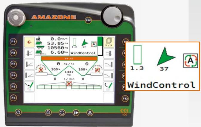
✔ La velocidad y la dirección del viento se muestran en el terminal
