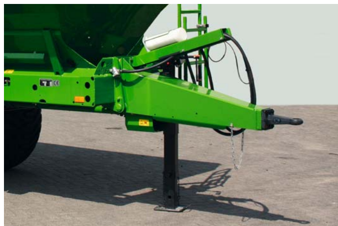
Enganche superior con argolla de tracción
