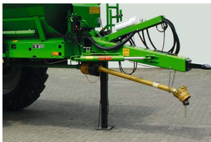
Lanza de dirección con cabeza esférica
