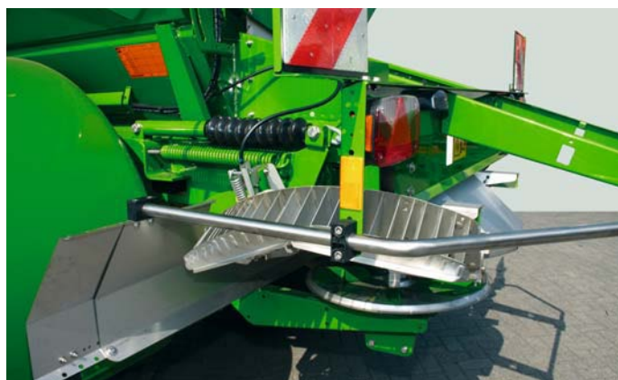
Limiter plegado hacia arriba para el esparcimiento normal
