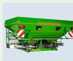
Esparcidora de dos discos ZA-M Ultra 3000 - 4200 l, 15 - 52 m
