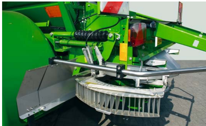
Limiter en posición de trabajo
