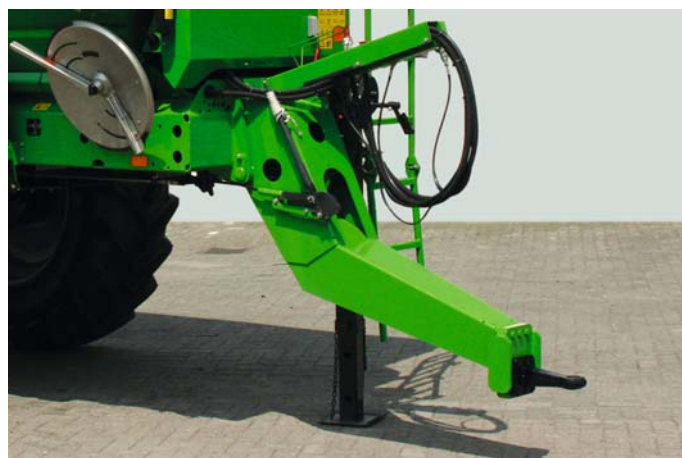
Enganche inferior con argolla de tracción
